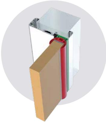
Egal wie breit Ihre Wand ist – wir finden die passende Zarge! Aluminiumzargen mit oder ohne Wanddickenausgleich liefern wir zweischalig mit Rund- oder Kantspiegel. Sie sind universell für Massiv- und Trockenbauwände einsetzbar und sogar für Rauch- und Brandschutztüren geeignet.
